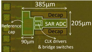
Fig. 4. Die photo in 65nm CMOS.
